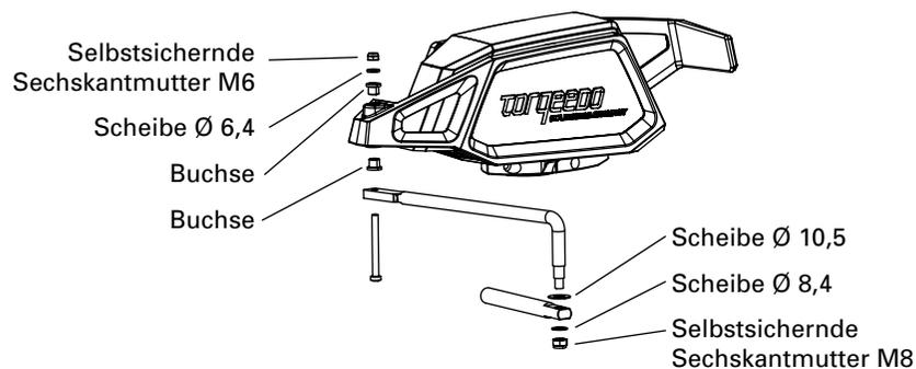
4. Befestigen Sie die weiteren Teile Ihres Fernlenksystems entsprechend der Anleitung des Herstellers.
