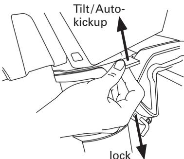
Der Kipperrhebel erlaubt in der „Tilt/Auto kick-up“ Position (Hebel oben) ein Hochkippen des Motors bei Grundberührung. In dieser Position sind Vollgas-Rückwärtsfahrt und Aufstoppen nicht möglich.
