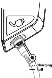
Die Ladebuchse des Akkus ist mit einem Stecker gekennzeichnet. Zum Laden wird das Netzteil mit Steckdose und Ladebuchse verbunden. Während des Ladevorgangs blinkt die Ladekontroll-Leuchte (Charging) im Batteriegehäuse. Ist der Ladevorgang abgeschlossen, leuchtet diese Leuchte permanent. Für genauere Informationen kann während des Ladevorgangs die Pinne mit dem Akku verbunden werden. In diesem Fall zeigt das Pinnen-Display die Funktion „Charging“ sowie den Ladestand in Prozent an.
