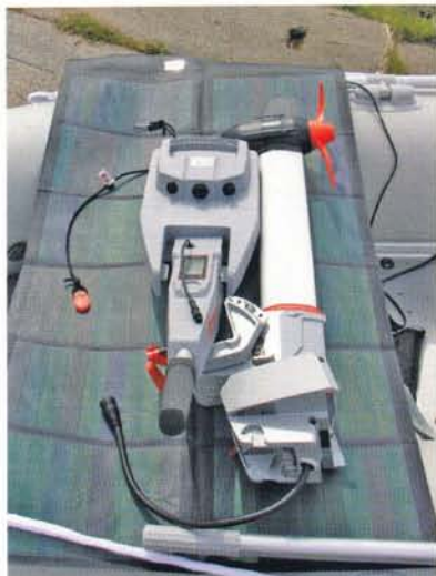
Ein autarkes System: Torqeedo 1003 – zum Transport zerlegt – auf dem als Zubehör lieferbaren Solarmodul.
