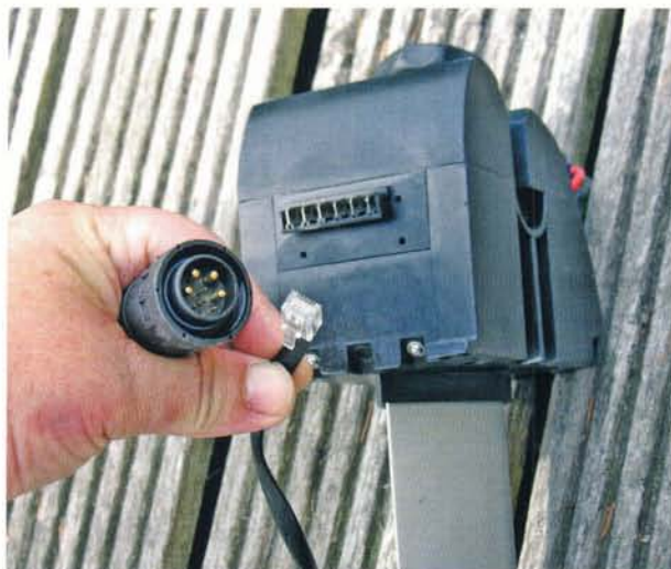
Der am Travel 800 verwendete Telefonstecker war nicht allzu korrosionsbeständig und ist bei dem 1003 durch einen wasserdichten Stecker mit vergoldeten Kontakten ersetzt.
