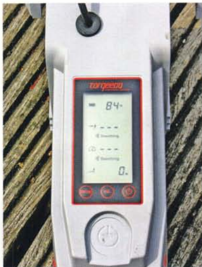
Batterieladestatus, Reichweite, Ge- schwindigkeit und Leistungseingang in Watt auf einen Blick.
