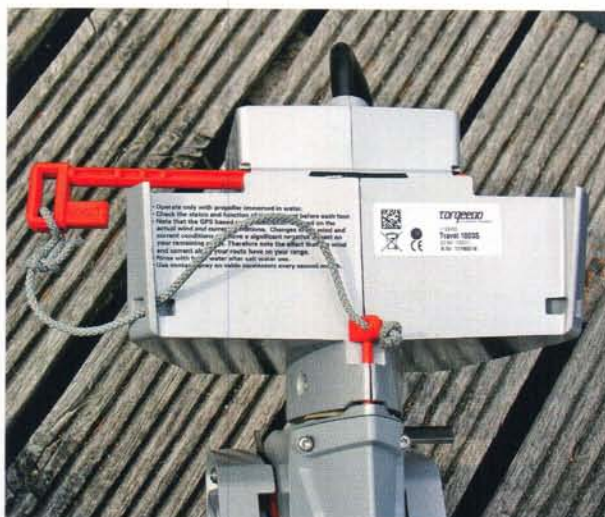
Mit dem unteren orangefarbenen Stift kann der Antrieb in Vorausrüstung fixiert werden; der obere Stift dient der Verriegelung der Batterie in der Halterung.
