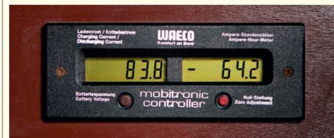
▲ Schnelle Aufnahmefähigkeit: Lithium-Akkus können in kürzester Zeit mit sehr hohem Ladestrom geladen werden. Allerdings verträgt das nicht jede Lichtmaschine. Und auch der Batteriekontroller muss auf die Lithium-Technologie angepasst werden
