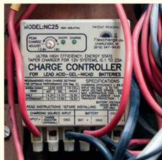
▲ Für Lithium-Akkus geeignet: Regler für Solarzellen und Windgeneratoren haben oftmals eine simple Möglichkeit die Ladeschlussspannung einzustellen
