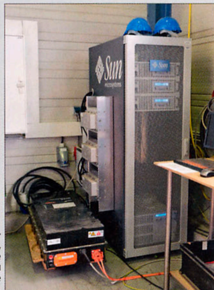
Un banc d'analyse, spécialement développé par Torquedo, permet de tester en interne la tenue à la surcharge, au vieillissement et au cyclage des batteries Deep Blue.
