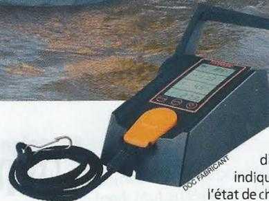
La manette de commande dispose d'un écran indiquant la vitesse, l'état de charge de la batterie, la puissance moteur et la distante restante.
