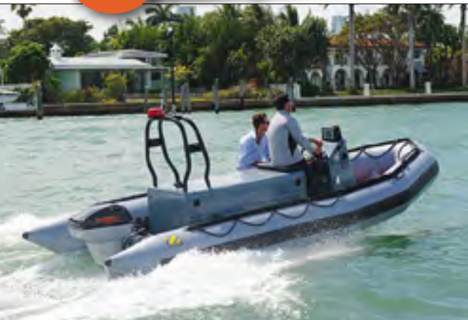
Équipé de trois batteries li-ion de 325 volts, ce Zodiac bénéficie d'une autonomie de 2 heures à 10 nœuds.
