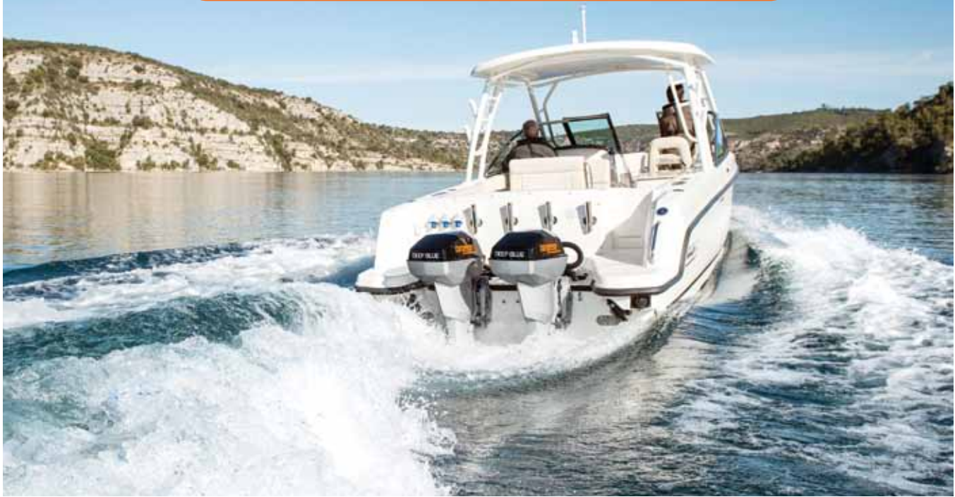
Wyjątkowość silnika Deep Blue polega przede wszystkim na dużej mocy odpowiadającej efektywnej sile ciągu 80-konnego silnika spalinowego
