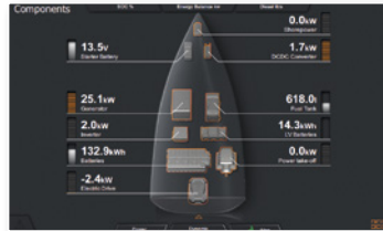
Gestione del sistema: Aggiornamenti di stato di tutti i componenti.
