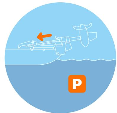
**Vite et bien rangé.** Ranger le moteur pour le transport n'a jamais été aussi simple. Tirez l'Ultralight 403 vers le haut et attachez le cordon élastique pour le fixer. Pour l'Ultralight 1103 AC, utilisez le système de serrage rapide.
