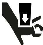
Attenzione Pericolo di schiacciamento
