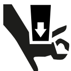
Precaución: peligro de aplastamiento
