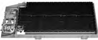
Fig. 9: Batería de alto voltaje
