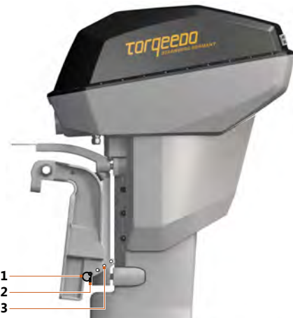
Fig. 19: Goupille de sécurité du boulon de stabilisation
