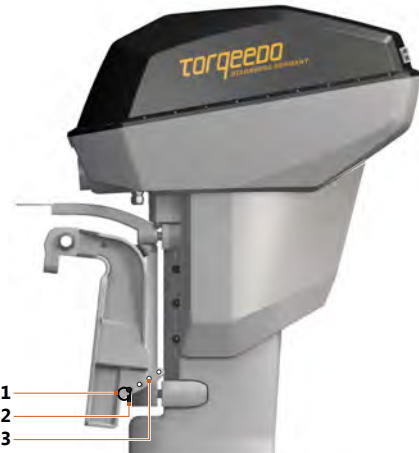
Fig. 68: Coppiglia di sicurezza perno di regolazione del trim
