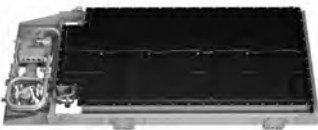
Fig. 58: Batteria ad alto voltaggio
