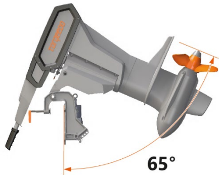
Joonis 24. Mootor täiesti üles kallutatud
