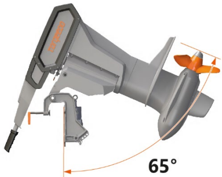
24 pav.: Variklis visiškai pakreiptas į viršų
