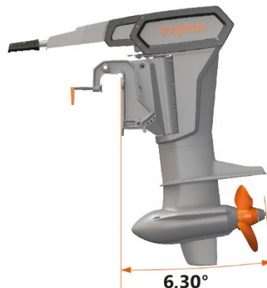
Fig. 25: Motorul este complet înclinat în jos
