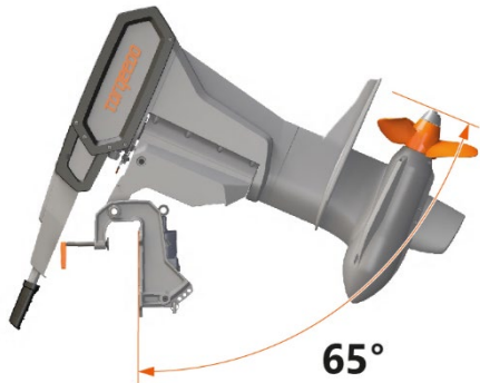
Obr. 24: Úplne vyklopený motor
