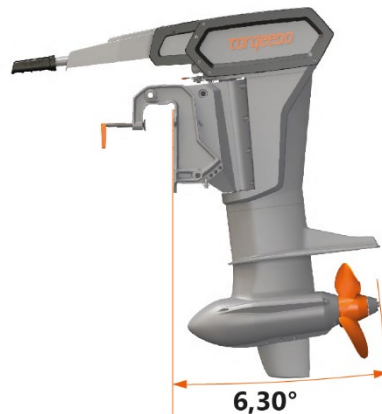
Obr. 25: Úplne sklopený motor
