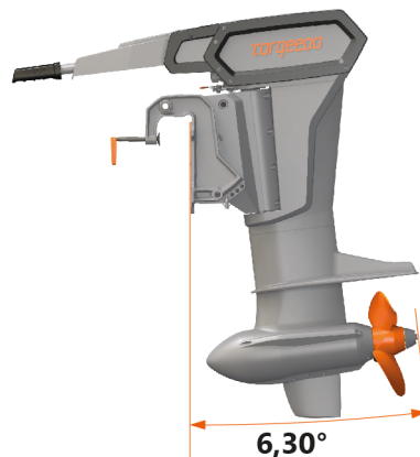
Fig. 25: Moteur entièrement abaissé
