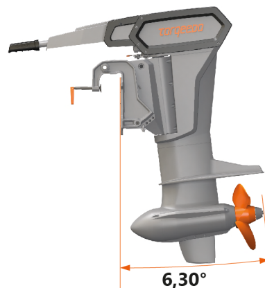
Fig. 25: Motore completamente abbassato
