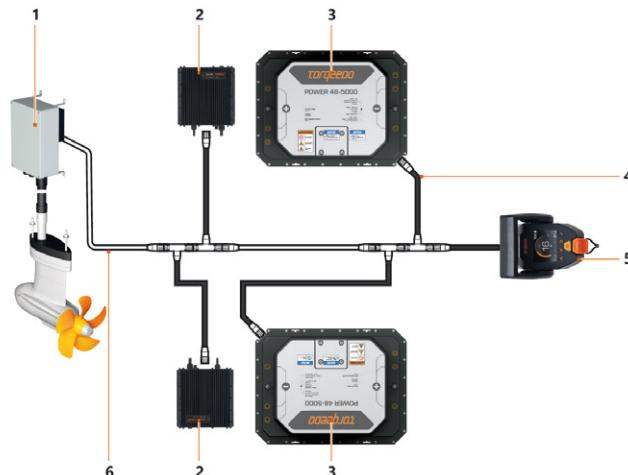
Fig. 49: Schematisk uppbyggnad av ett TorqLink-nätverk med fjärrgasreglaget 1976-00
