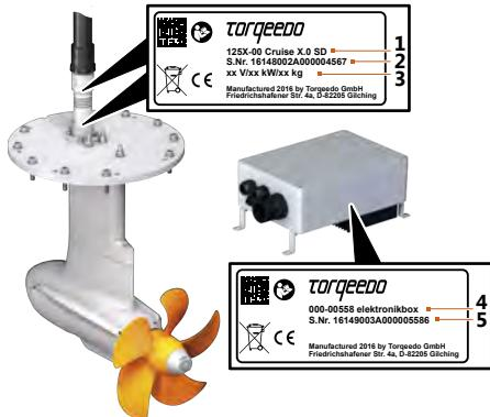
Fig. 1: Typskyltar motor och elektronikbox
