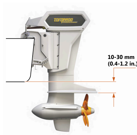
Fig. 5: Posizione di montaggio
