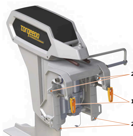
Fig. 4: Fissaggio allo specchio di poppa
