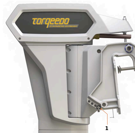
Fig. 12: Coppiglia di sicurezza perno di regolazione del trim
