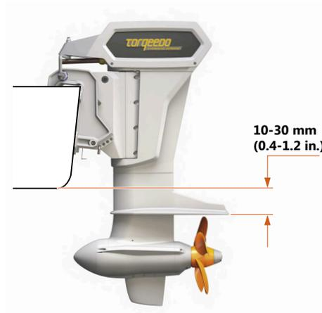
Fig. 37: Installation position
