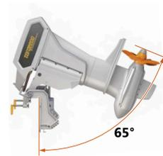
Abb. 25: Motor vollständig hochgekippt
