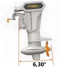
Abb. 26: Motor vollständig heruntergekippt
