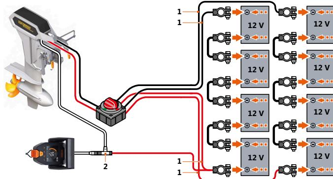
Fig. 46: Schakelschema loodbatterijen
