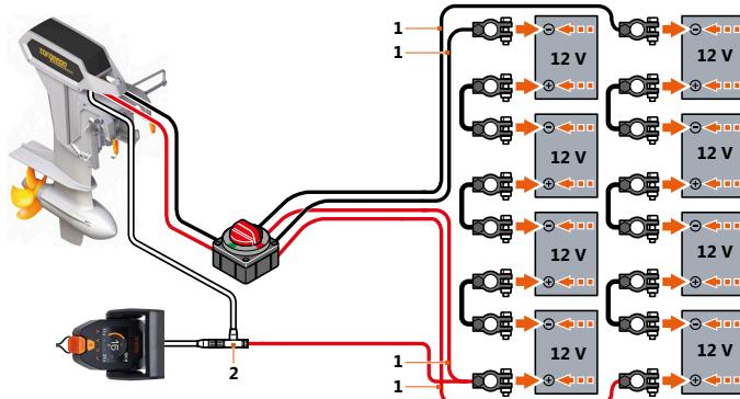
Fig. 16: Schéma électrique des batteries au plomb
