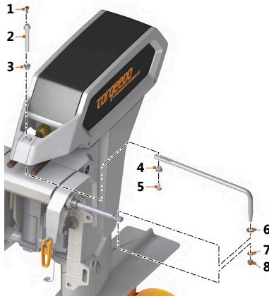
Fig. 39: Onderdelen afstandsbesturing
