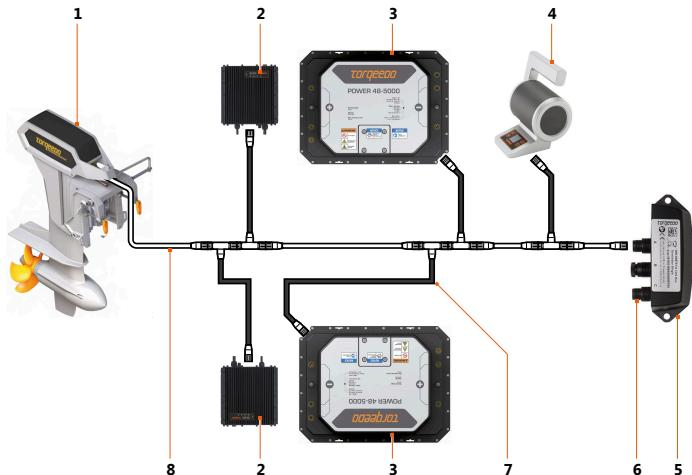
Fig. 42: Schematische opbouw van een TorqLink netwerk met de gashendel 1949- 1952
