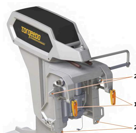
Fig. 6: Étrier du tableau arrière
