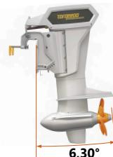
Fig. 56: Motor volledig omlaag gekanteld
