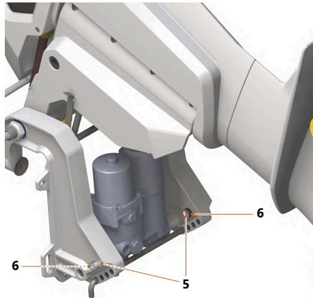
Fig. 29: Anodes sacrificielles de l'étrier du tableau arrière
