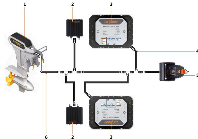
Fig. 11: Structure schématique d'un réseau TorqLink avec la manette de commande 1976-00
