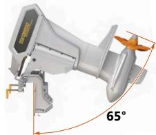
Fig. 55: Motor volledig omhoog gekanteld
