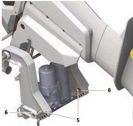
Fig. 59: Anode spiegelbevestiging
