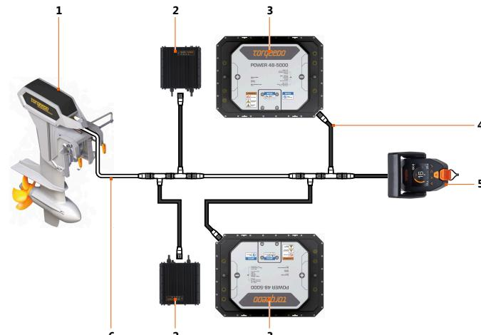
Fig. 41: Schematische opbouw van een TorqLink netwerk met de gashendel 1976-00
