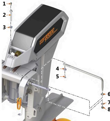
Fig. 9: Éléments de la commande à distance
