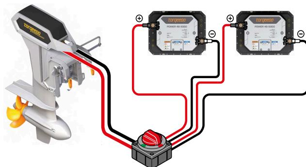
Fig. 15: Schéma électrique de la Power 48-5000
