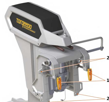
Fig. 6: Étrier du tableau arrière
