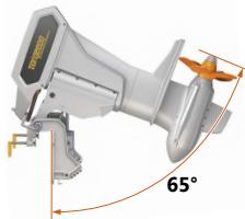
Fig. 69: Motor volledig omhoog gekanteld
