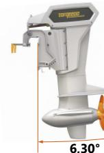
Fig. 70: Motor volledig omlaag gekanteld
