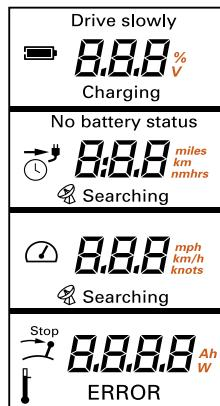
Fig. 60: Multifunctionele weergave set-up-menu
