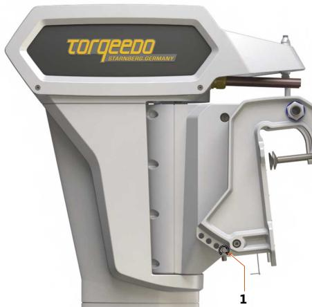
Fig. 12: Goupille de sécurité du boulon de stabilisation
