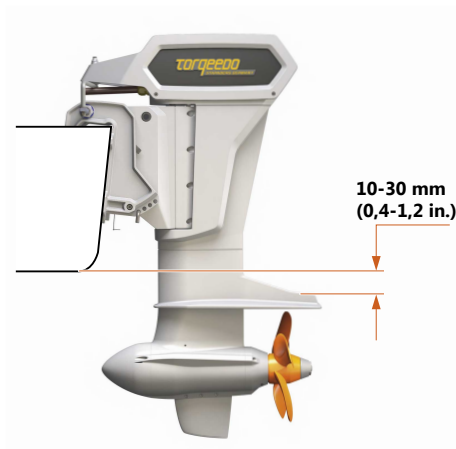
Fig. 7: Posizione di montaggio
