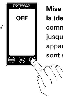
**Mise hors tension du moteur et de la (des) batterie(s) :** maintenez le commutateur marche/arrêt appuyé jusqu'à ce que le symbole OFF apparaisse sur l'écran : les batteries sont elles aussi hors tension (faible décharge spontanée)
