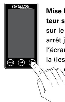
**Mise hors tension du moteur seul :** pression brève sur le commutateur marche/arrêt jusqu'à extinction de l'écran : le moteur est hors, la (les) batterie(s) sont encore sous tension.
