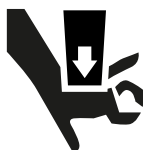
Precaución: riesgo de aplastamiento
