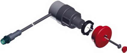
6. ábra: Vészleállító kapcsoló – beszerelési rajz
