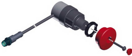
6 pav.: Avarinio stabdymo jungiklio sumontavimo brėžinys
