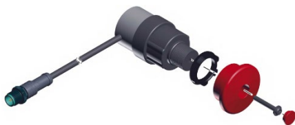
6. att. Avārijaptures slēdža iebūvēšanas shēma
