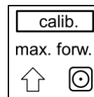
Obr. 36: Zobrazenie maximálnej prednej pozície na displeji
