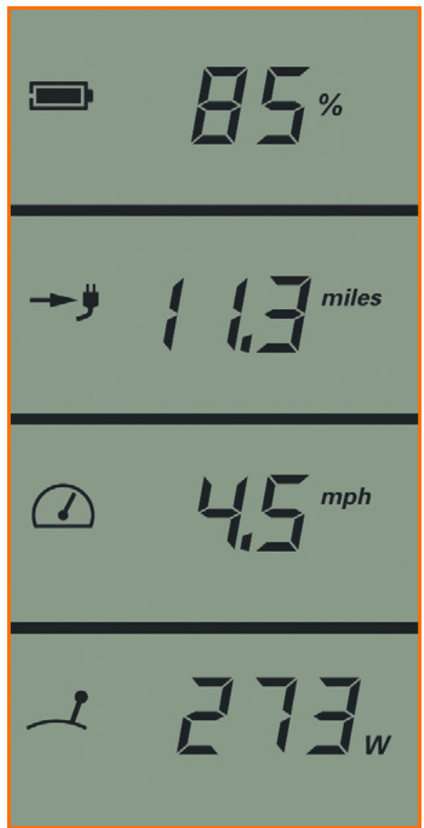
Elektronischer Gashebel mit Bordcomputer-Bildschirm informiert in Echtzeit über Batterieladestatus, Geschwindigkeit über Grund und Restreichweite.
